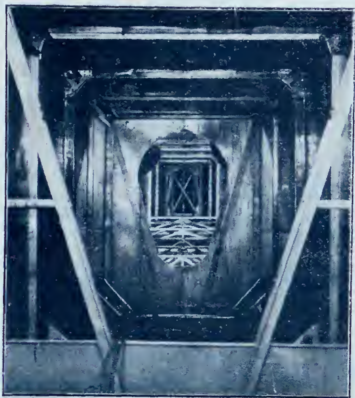
Fig. 4. - Interno della fusoliera del ROHRBACH Ro III
